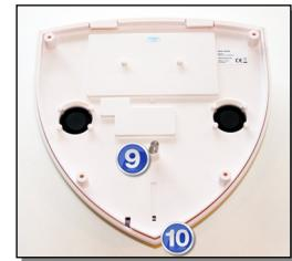
Monter sirenen. Sørg for at fjederen på bagsiden (Figur 9) er trykket ind mod underlaget. Skru herefter skruen i bunden (Figur 10) i sirenen igen.
