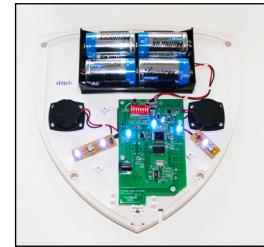
Skift tænd/sluk knappen (figur 2.) til position "ON" – blå lys tænder.
