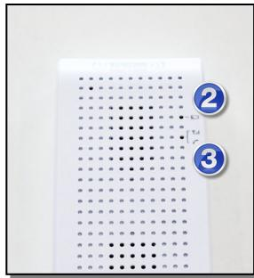
I batterirummet isættes de 4 batterier samt strømforsyningen. Batterilyset (Figur 2) og signallyset (Figur 3) vil lyse på forsiden af enheden. Når disse efter ca. 10 sekunder slukker, er GSM Dialeren forbundet til netværket.
